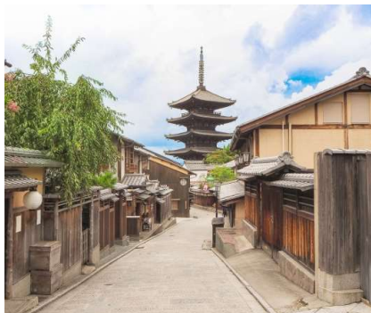
無電柱化された街並み
