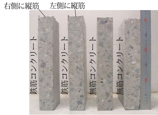
写真-4 鉄筋コンクリートと無筋コンクリートの断面の粗骨材の分布(120s)
